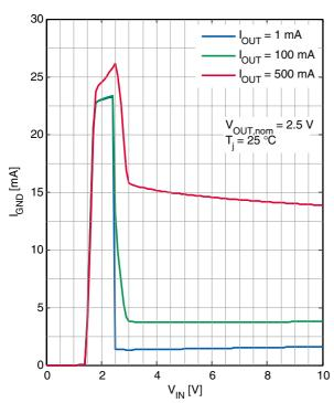
GND Pin Current  $I_{\rm GND}$  versus Input Voltage  $V_{\rm IN}$  ( $V_{\rm OUT,nom}$  = 2.5 V)
