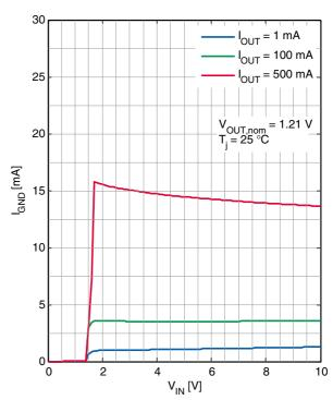
GND Pin Current  $I_{\rm GND}$  versus Input Voltage  $V_{\rm IN}$  ( $V_{\rm OUT,nom}$  = 1.21 V)
