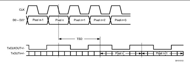
FIGURE 7. DS90C185 Propagation Delay
