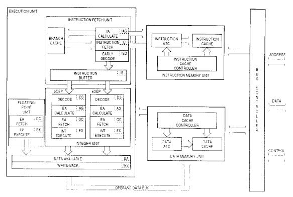
Figure 1-1. MC68060 Block Diagram
