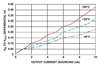
FIGURE 26. MINIMUM  $\mathrm{V_{IN}}$  TO  $\mathrm{V_{OUT}}$  DIFFERENTIAL vs OUTPUT CURRENT
