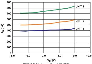
FIGURE 29.  $I_{\rm IN}$  vs  $V_{\rm IN}$  (3 UNITS)
