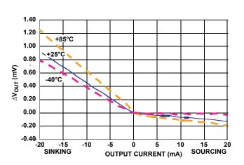
FIGURE 18. LOAD REGULATION OVER TEMPERATURE
