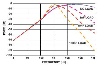
FIGURE 21. PSSR vs CAP LOAD
