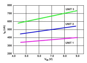
FIGURE 2. I<sub>IN</sub> vs V<sub>IN</sub> (3 UNITS)
