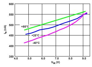
FIGURE 3. I<sub>IN</sub> vs V<sub>IN</sub>
