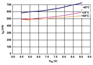
FIGURE 28.  $I_{\rm IN}$  vs  $V_{\rm IN}$
