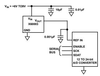
FIGURE 32. BATTERY-POWERED DATA CONVERTER CIRCUITS
