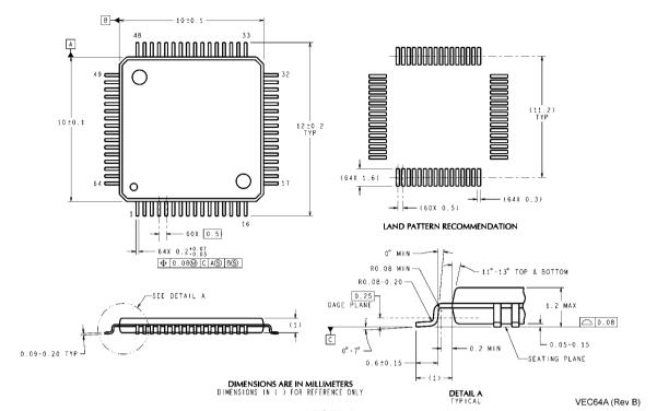
64-Lead TQFP Package Ordering Number ADC10DL065CIVS NS Package Number VECO64A
