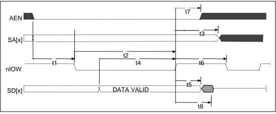
FIGURE 10 - 8051 IO WRITE CYCLE
