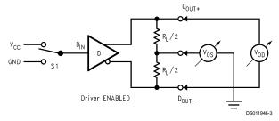
FIGURE 1. Driver  $\rm V_{\rm OD}$  and  $\rm V_{\rm OS}$  Test Circuit
