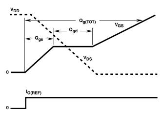
FIGURE 20. GATE CHARGE WAVEFORMS
