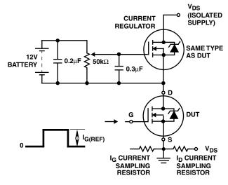
FIGURE 19. GATE CHARGE TEST CIRCUIT
