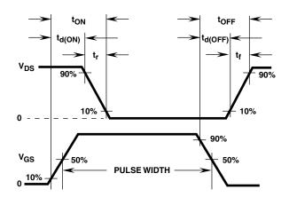
FIGURE 18. RESISTIVE SWITCHING WAVEFORMS
