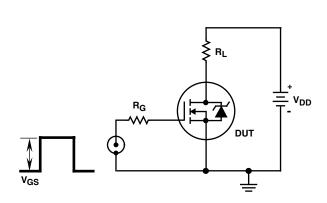
FIGURE 17. SWITCHING TIME TEST CIRCUIT
