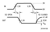
FIGURE 3. t<sub>ZL</sub>, t<sub>LZ</sub> (*Note 9, Note 10, Note 12, Note 13*)
