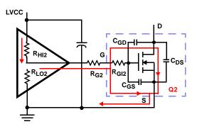
FIGURE 4. TYPICAL LOWER-GATE DRIVE TURN-ON PATH
