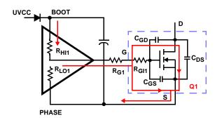
FIGURE 3. TYPICAL UPPER-GATE DRIVE TURN-ON PATH
