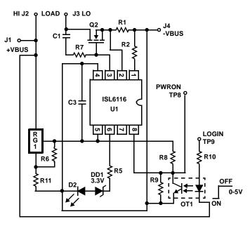
FIGURE 21. ISL6115EVAL1 HIGH SIDE SWITCH APPLICATION
