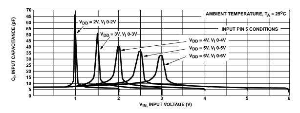
FIGURE 3. INPUT CAPACITANCE AS A FUNCTION OF INPUT VOLTAGE
