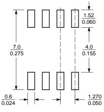
$\left(\frac{\text{mm}}{\text{inches}}\right)$ SCALE 6:1
