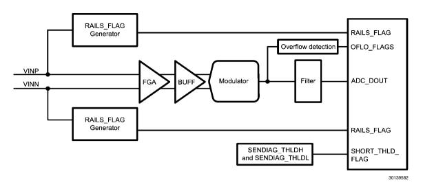
FIGURE 18. Sensor Diagnostic Flags Diagram
