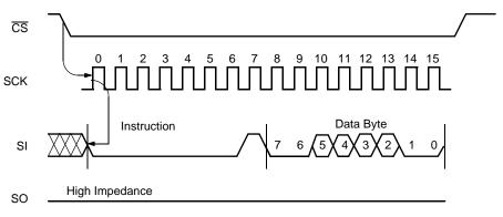
FIGURE 7. WRITE STATUS REGISTER SEQUENCE
