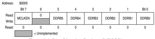
Figure 9-6. Data Direction Register B (DDRB)
