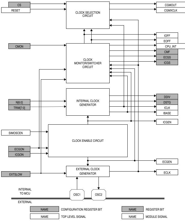
Figure 6-2. ICG Module Block Diagram
