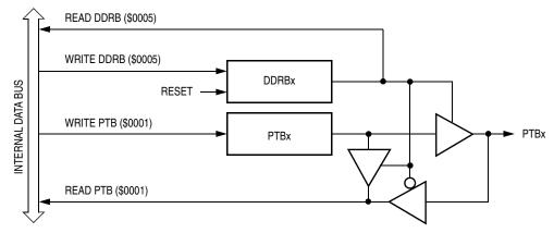
Figure 9-7. Port B I/O Circuit
