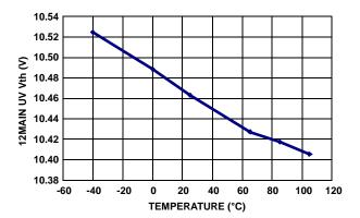
FIGURE 28. 12MAIN POWER GOOD THRESHOLD VOLTAGE vs TEMPERATURE
