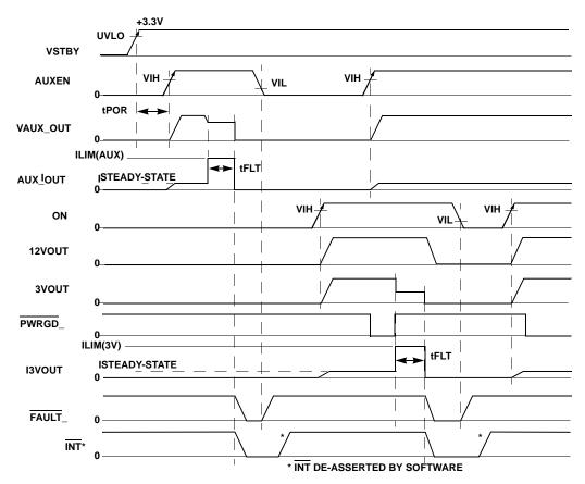
FIGURE 16. HOT-PLUG INTERFACE OPERATION
