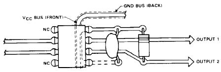
FIGURE 3. RECOMMENDED PRINTED CIRCUIT BOARD LAYOUT
