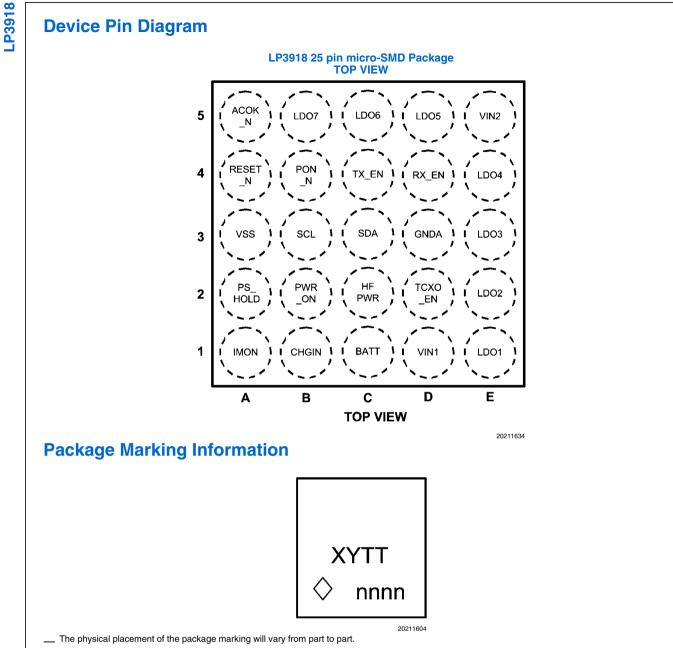
\_\_\_ Date Code. XYTT format. 'XY' 2 digit date code; 'TT' - dierun code
