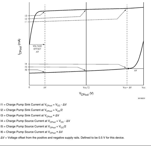
12.1 CHARGE PUMP OUTPUT CURRENT MAGNITUDE VARIATION VS. CHARGE PUMP OUTPUT VOLTAGE
