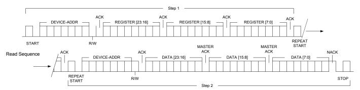
FIGURE 11. I<sup>2</sup>C READ SEQUENCE OPERATION
