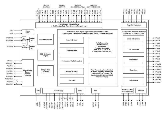
FIGURE 4. D2-7xx83 IC FUNCTIONAL BLOCK DIAGRAM
