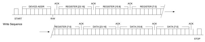
FIGURE 10. I<sup>2</sup>C WRITE SEQUENCE OPERATION
