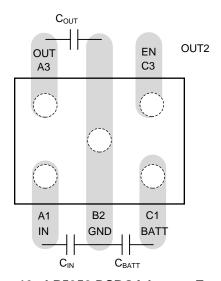
Figure 19. LP5952 DSBGA Layout Example
