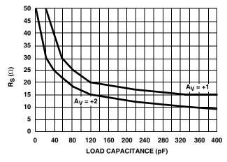
FIGURE 1. RECOMMENDED SERIES RESISTOR vs LOAD CAPACITANCE
