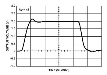
FIGURE 7. LARGE SIGNAL POSITIVE PULSE RESPONSE
