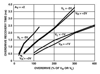
FIGURE 32. OVERDRIVE RECOVERY TIME vs OVERDRIVE
