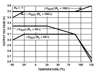
FIGURE 33. OUTPUT VOLTAGE vs TEMPERATURE
