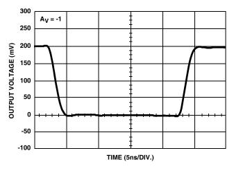
FIGURE 14. SMALL SIGNAL POSITIVE PULSE RESPONSE
