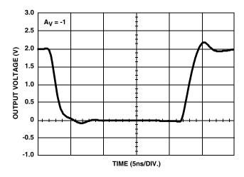
FIGURE 15. LARGE SIGNAL POSITIVE PULSE RESPONSE
