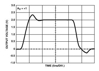
FIGURE 11. LARGE SIGNAL POSITIVE PULSE RESPONSE
