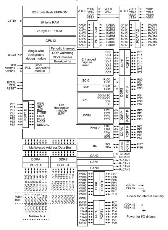
Figure 1-1. MC68HC912DT128A Block Diagram
