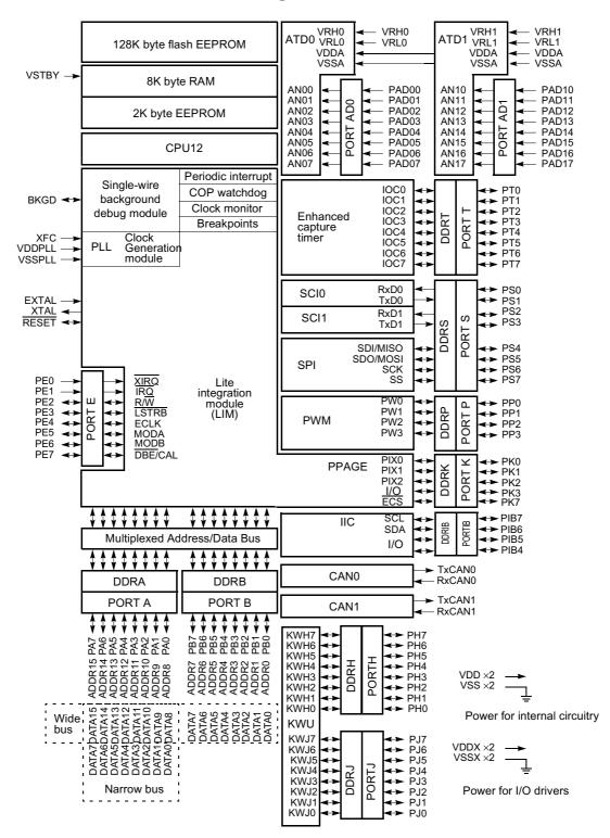
Figure 1-2. MC68HC912DG128A Block Diagram
