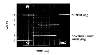
$SSM2402 T_{ON}/T_{OFF} Switching Response$
