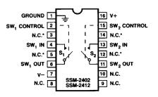
\* GUARD PINS FOR INPUT/OUTPUT ISOLATION (GROUND FOR BEST PERFORMANCE)
