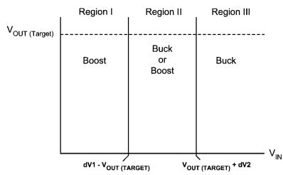
FIGURE 7. V<sub>OUT</sub> vs V<sub>IN</sub> Transition
