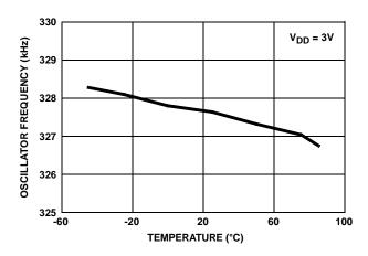
FIGURE 20. OSCILLATOR FREQUENCY vs TEMPERATURE
