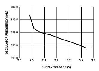
FIGURE 16. OSCILLATOR FREQUENCY vs SUPPLY VOLTAGE
