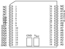
34-Pin PowerCap Module (PCM) (Uses DS9034PC PowerCap)
