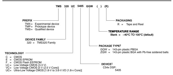
Figure 4-1. TMS320UC5405 DSP Device Nomenclature
