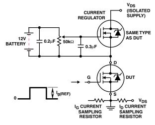
FIGURE 19. GATE CHARGE TEST CIRCUIT
