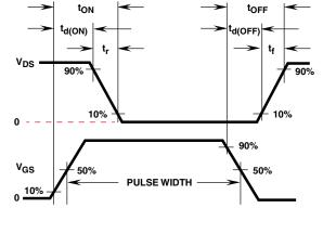
FIGURE 18. RESISTIVE SWITCHING WAVEFORMS
