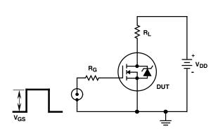
FIGURE 17. SWITCHING TIME TEST CIRCUIT
