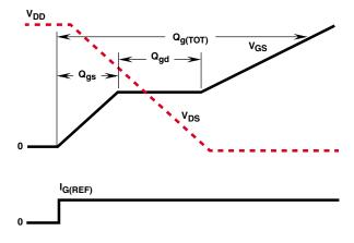
FIGURE 20. GATE CHARGE WAVEFORMS
