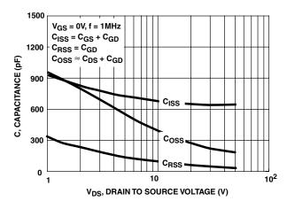
FIGURE 11. CAPACITANCE vs DRAIN TO SOURCE VOLTAGE
