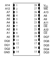
28-Pin ENCAPSULATED PACKAGE 740-mil EXTENDED
