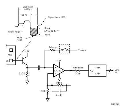
FIGURE 14. CCD Amplifier
