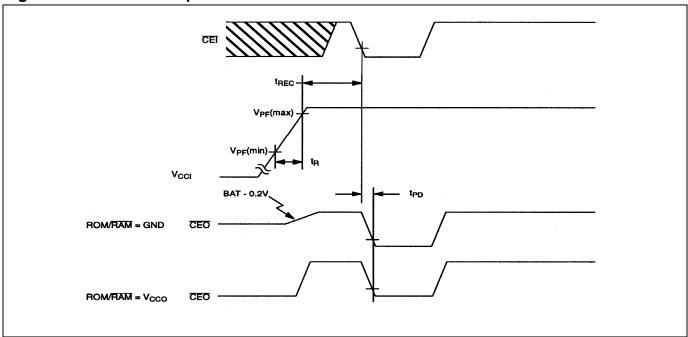
Figure 14. 3.3V Power-Down Condition
