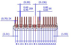
LEAD PITCH (TOLERANCE : ±0.30) A : 1.778 B : 2.050 C : 2.531
