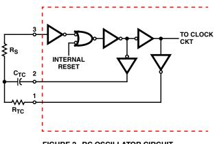
FIGURE 2. RC OSCILLATOR CIRCUIT
